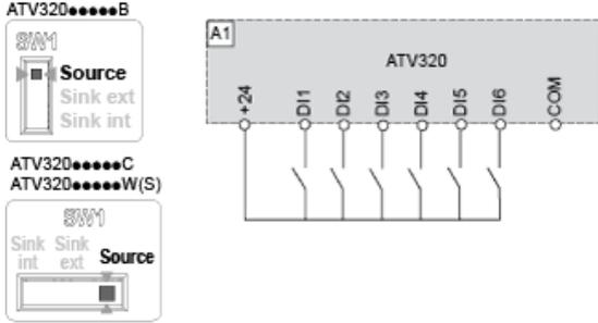
Conmutador SW1 fijado en posición "fuente" y uso de una fuente de alimentación externa para las entradas digitales.
