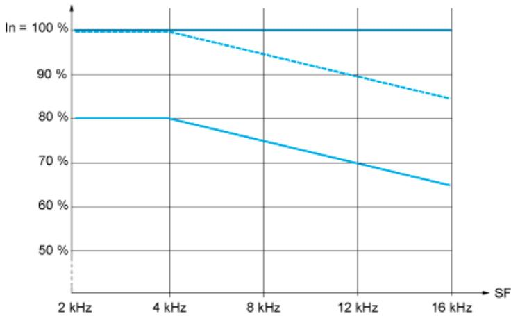
— 40 °C (104 °F) - Tipo de montaje A, B y C
